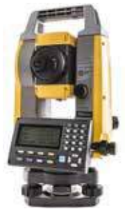
Topcon GM-50 Reflektörsüz 500 metreye kadar Prizma EDM Aralığı 4,000 m'ye kadar Zamanı ölçmek İnce: 0,9 s (İlk 1.7 sn.)
